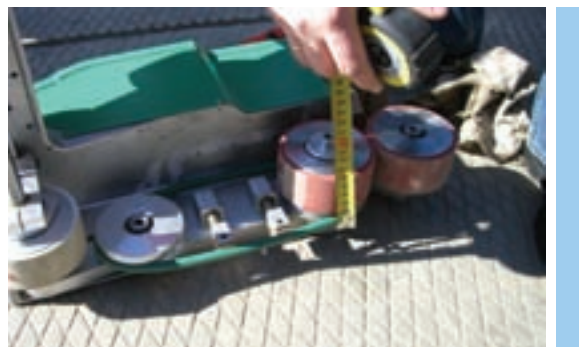
Рис. 3.5.5 Ширина прикаточной поверхности Leister Varimat, равная 60 мм
