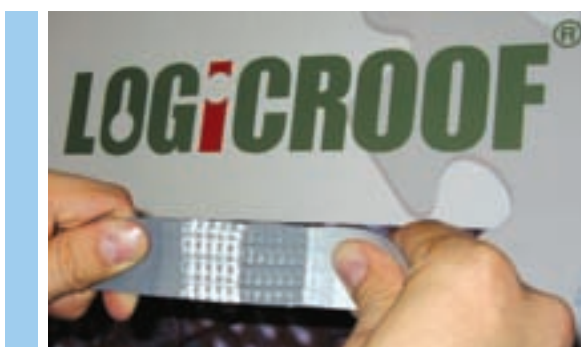
Рис. 5.2.3 Когезионный разрыв сварного шва неармированной и армированной мембраны
