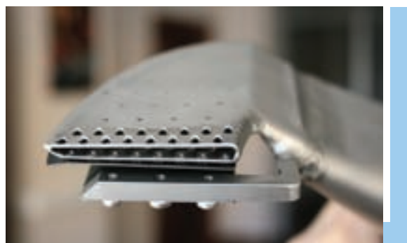
Рис. 5.2.6 Насадка на сварочный автомат, разрушающая олигомерную пленку
