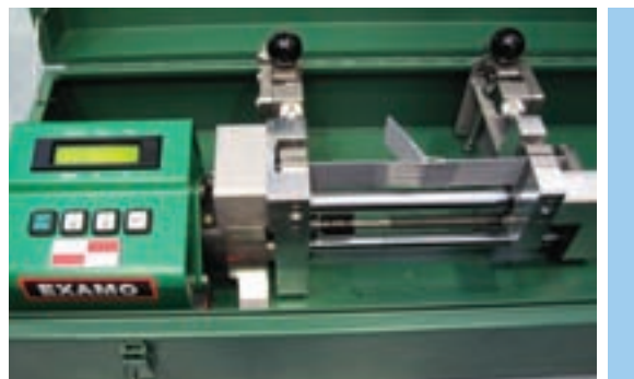
Рис. 5.2.5 Проверка качества сварного шва при помощи Leister Examo
