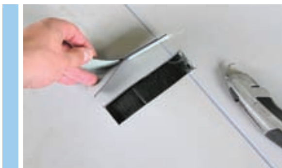
Рис. 5.2.10 Вырезание тестовой полоски из сварного шва
