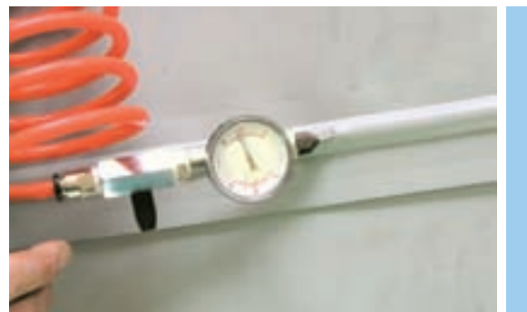
Рис. 5.2.13 Проверка герметичности с использованием сквозного канала
