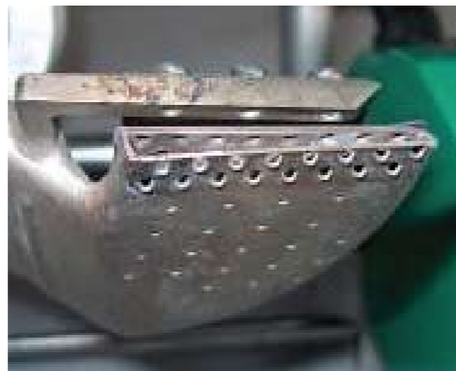
Рисунок 4.2.6 Насадка на сварочный автомат, разрушающая олигомерную пленку.
